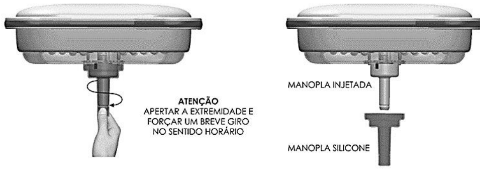
Figura 49 - Desacoplando a manopla de silicone
