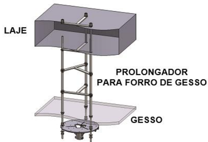
Figura 20 – Fixação na laje com rebaixo de gesso
