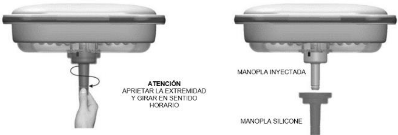
Figura 49- Desmontar la manopla de silicona
