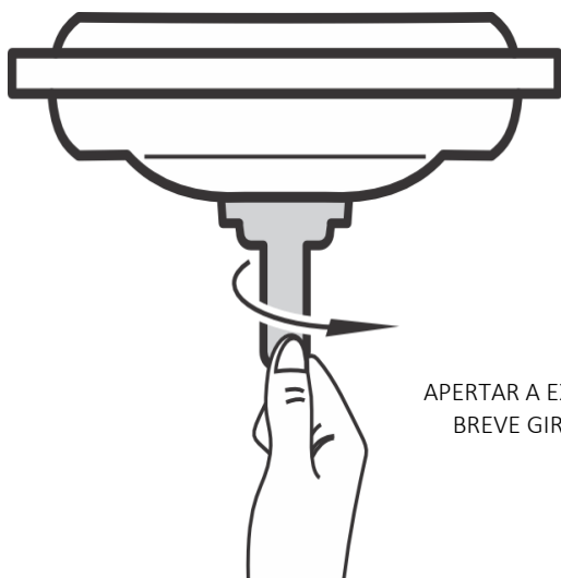
Figura 49 - Desacoplando a manopla de silicone
